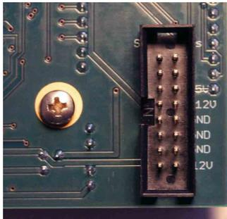
Jomox ModBase09/ModBrane11 Euro Rack Supply Stecker. *Hier* schließen Sie bitte die Stromversorgung vom Euro-Rack Systembus an.
