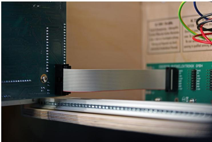
Dann montieren Sie das ganze Modul auf den Gewindeschienen mit den mitgelieferten M3-Schrauben. Falls Sie noch Midi-Kabel anschließen möchten, tun Sie das bitte vor dem Verschrauben.
