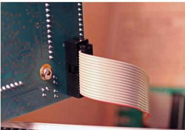
Schließen Sie das andere Ende des Flachbandkabels am Modul wie auf dem Bild gezeigt an. Die Kabel sind recht kurz, was bei der recht hohen Stromaufnahme elektrisch von Vorteil ist.
