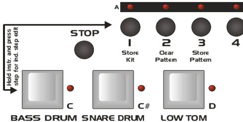
Um einen oder mehrere Steps einer Instrumentenspur in den "Individual Step Edit Mode" zu versetzen, müssen Sie die **(Instrumenten)**-Taste gedrückt halten und gleichzeitig mit den **(Step)**-Tasten die gewünschten Steps auswählen. Die Step-LEDs der entsprechenden Steps blinken nun. Mit den Instrumenten-Tasten können Sie wie gewohnt die Instrumentenspuren wechseln.
