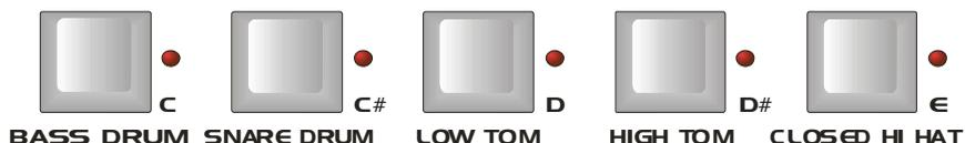
Mit den **(Instrumenten)**-Tasten können Sie nun eine zu bearbeitende Instrumentenspur auswählen. Jedes Instrument hat seine eigene Spur, deren Beatprogrammierung sofort angezeigt wird. Sie können selbstverständlich bei laufendem Sequenzer jederzeit zwischen den einzelnen Spuren umschalten. Die 16 **(Step)**-LEDs zeigen an, an welchen Steps des Patterns das ausgewählte Instrument gespielt wird - Die entsprechenden LEDs leuchten rot.
