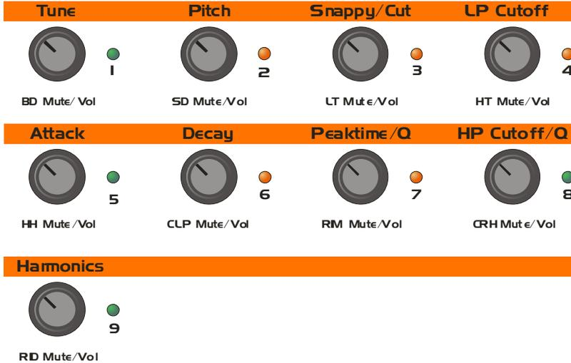
Sie können zu jeder Zeit und in jedem Modus die Instrumente stummschalten (Mute), indem Sie auf einen der abgebildeten Encoder 1-9 klicken. Wenn das Instrument gemuted ist, blinkt die zugehörige LED rot.
